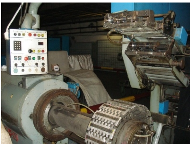
Установленные новый шкаф и панель управления (необходимость в огромном количестве кнопок отпала после модернизации интерфейса)
